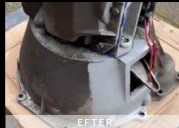
Afrensning olierester mm. på gearkasse i aluminium
